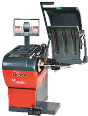
Balancadora de ruedas electrónica 3D, para auto, camionetas y motocicletas con aditamento opcional, monitor TFT, sistema de bloqueo mecánico, medición de ancho con sonar, interior con anillo de luz y puntero láser. Hasta rin de 40" de diámetro y capacidad de carga de hasta 80kgs
